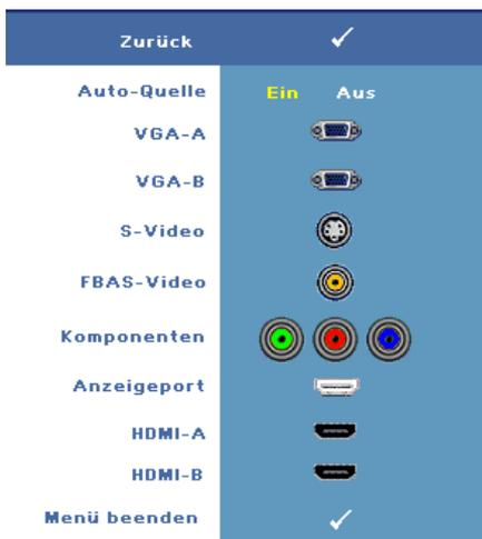
**AUTO-QUELLE**—Wählen Sie **Ein** (Vorgabe), um verfügbare Eingangssignale automatisch erkennen zu lassen. Wenn Sie bei eingeschaltetem Projektor die Taste **Quelle** drücken, findet er automatisch das nächste verfügbare Eingangssignal. Wählen Sie **Aus**, um das aktuelle Eingangssignal zu speichern. Wenn Sie die **Quelle**-Taste betätigen, wenn **Auto-Quelle** auf **Aus** eingestellt ist, können Sie das Eingangssignal manuell auswählen.
