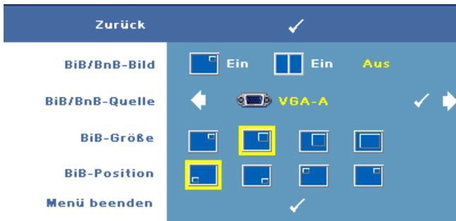
**ANMERKUNG:** Beim Tauschen der Anzeigen im Vordergrund und Hintergrund hängt die kleinste Bildgröße der Vordergrund-Anzeige von den verschiedenen Kombinationen von PIP-Signalquellen ab.
