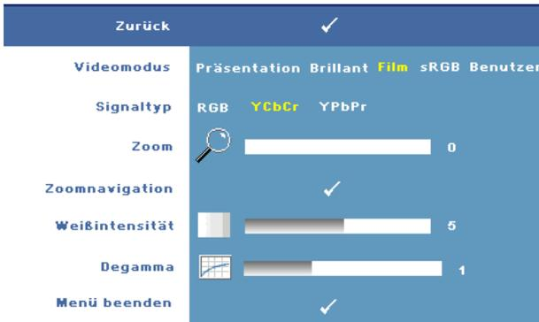
**VIDEOMODUS**—Ermöglicht die Optimierung des Projektor-Anzeigemodus: Präsentation, Brillant, Film, sRGB (bietet eine exaktere Farbwiedergabe) und Benutzer (legt Ihre bevorzugten Einstellungen für diese beiden Optionen fest). Wenn Sie Weißintensität oder Degamma einstellen, schaltet der Projektor automatisch auf Benutzer um.
