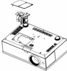
**⚠ VORSICHT: Berühren Sie niemals Lampe oder Lampenglas. Projektorlampen sind leicht zerbrechlich und können bereits bei Berührung beschädigt werden.**
