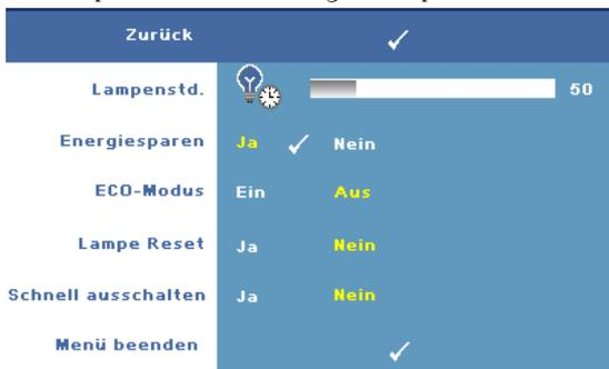
**LAMPENSTD.**—Hier werden die Betriebsstunden seit dem Zurücksetzen des Lampen-Timers angezeigt.
